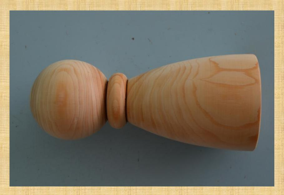
Закрепим на станке заготовку меньшего размера, выполним черновое точение (два разных диаметра)
